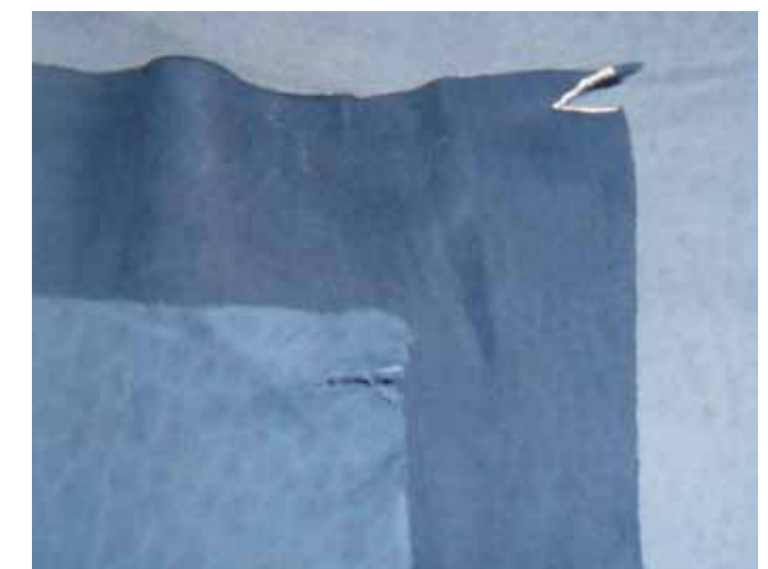
Figure 3. Comparison among specimens for the improvement of the conditions on a pilot scale (at the top – long bath, in the middle – silane before the dye, at the bottom – improved condition). Figura 3. Confronto provini per l'ottimizzazione delle condizioni su scala pilota (in alto bagno lungo, al centro silano prima del colorante, in basso condizione ottimizzata)
