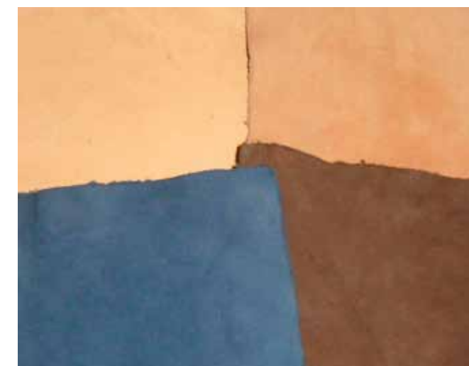
Figure 2. Comparison among specimens achieved from pilot tests with silane – three natural and one synthetic dyes (dark brown on the right). Figura 2. Confronto provini ottenuti da prove pilota con silano – tre coloranti naturali e uno sintetico (bruno scuro in basso a destra)
